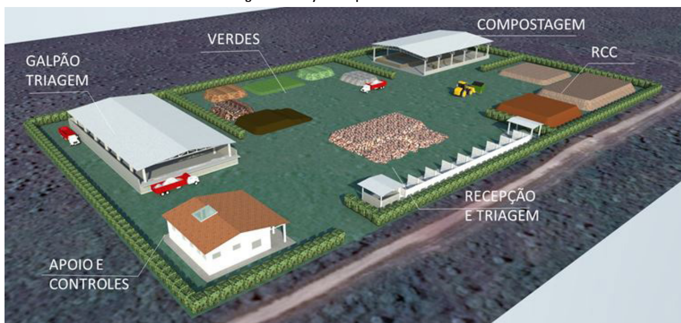
Figura 10 – Layout esquemático da CMR
